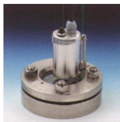
Projecteur USL13 monté sur hublot DIN 28120 avec une charnière
