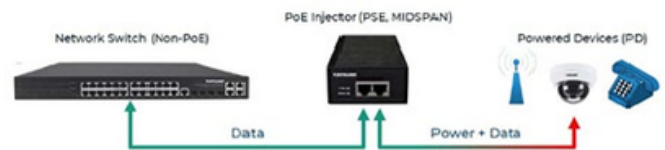
Exemple d'installation avec injecteur PoE :
