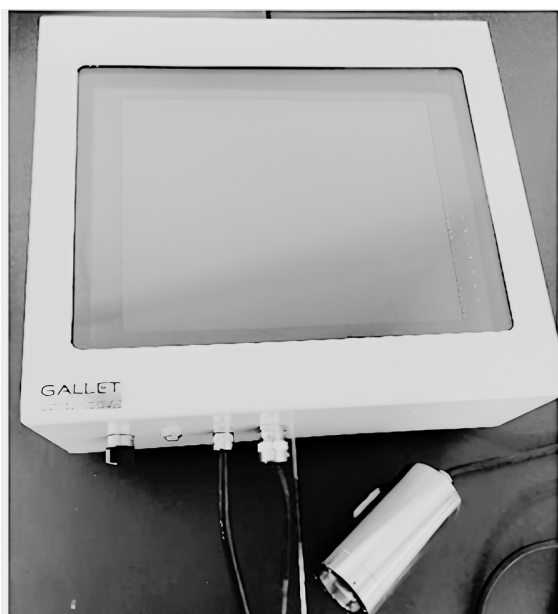
Boitier écran ATEX pour écran 17" associé à la caméra ATEX K55 câble 20m
